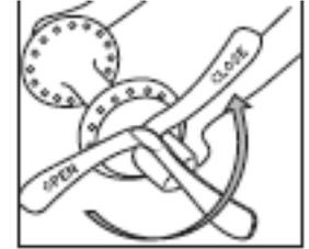
Figure 34 - Mouvement correct du levier
