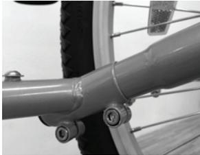
Fig 1: Insérer les barres de chargement dans les fourreaux
