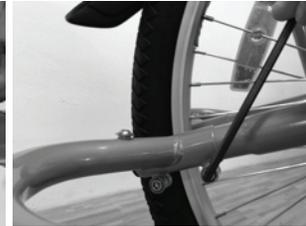
Fig 4: Serrer les vis des fourreaux
